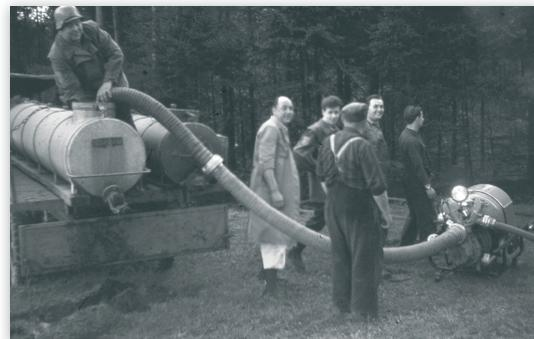
Auf Grund der steigenden Feuerlöscheinsätze wurde 1965 durch den damaligen Landkreis Kemnath ein neues Tanklöschfahrzeug TLF 16 mit 2400 Liter Löschwassertank, vier umluftunabhängigen Atemschutzgeräten, moderner Schaumlöschanlage sowie weiterer neuer feuerwehrtechnischer Ausrüstung zur Brandbekämpfung beschafft. Der damalige Kaufpreis betrug
