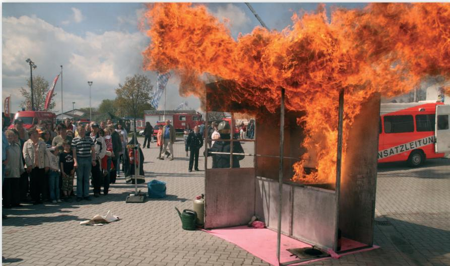
Vorführung durch die Versicherungskammer Bayern: Brandszenario "Fettexplosion" bei Anwendung falscher Löschmittel.
